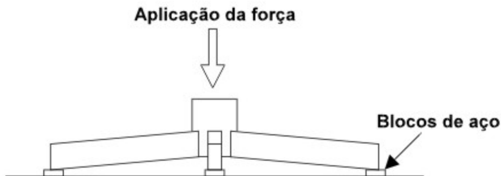
Figura 30 - Ensaio de carga estática na base
